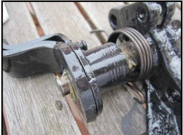
Mettre le cerclips maintenant la pédale de frein en place. Enfoncer la pédale d'embrayage en veillant à l'alignement du trou de la goupille.
