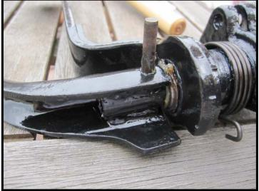
Il ne reste plus qu'à mettre la commande d'accélérateur, et la pédale en faisant attention au sens du ressort de rappel.
